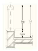
ht: altura total; hp: altura da proteção do guarda corpo; hm: altura da mureta.
