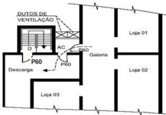
Figura 25 – Acesso de galeria comercial à descarga
