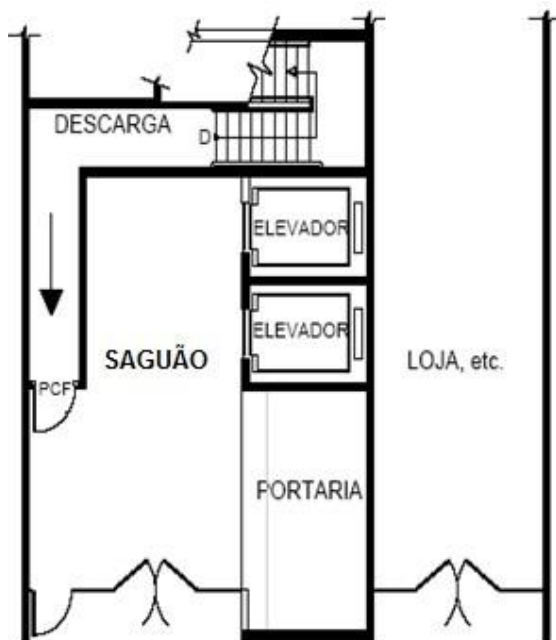
Figura 23 – Descarga através de hall térreo enclausurado
