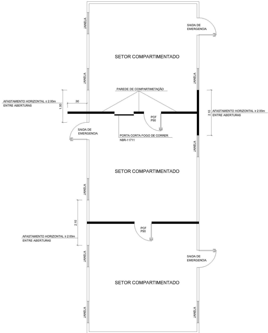
Figura 1 - Exemplo de compartimentação horizontal
