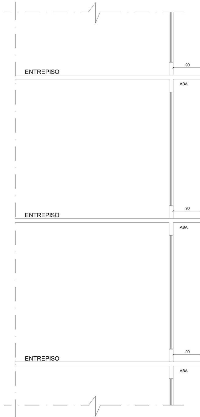
Figura 3 - Exemplo de compartimentação vertical (abas)
