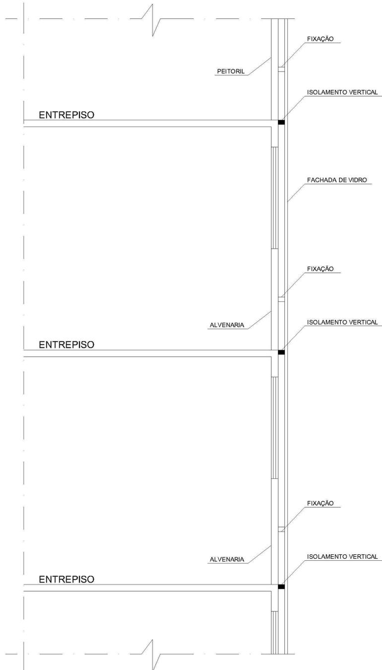
Figura 4 - Exemplo de compartimentação vertical (fachada envidraçada)
