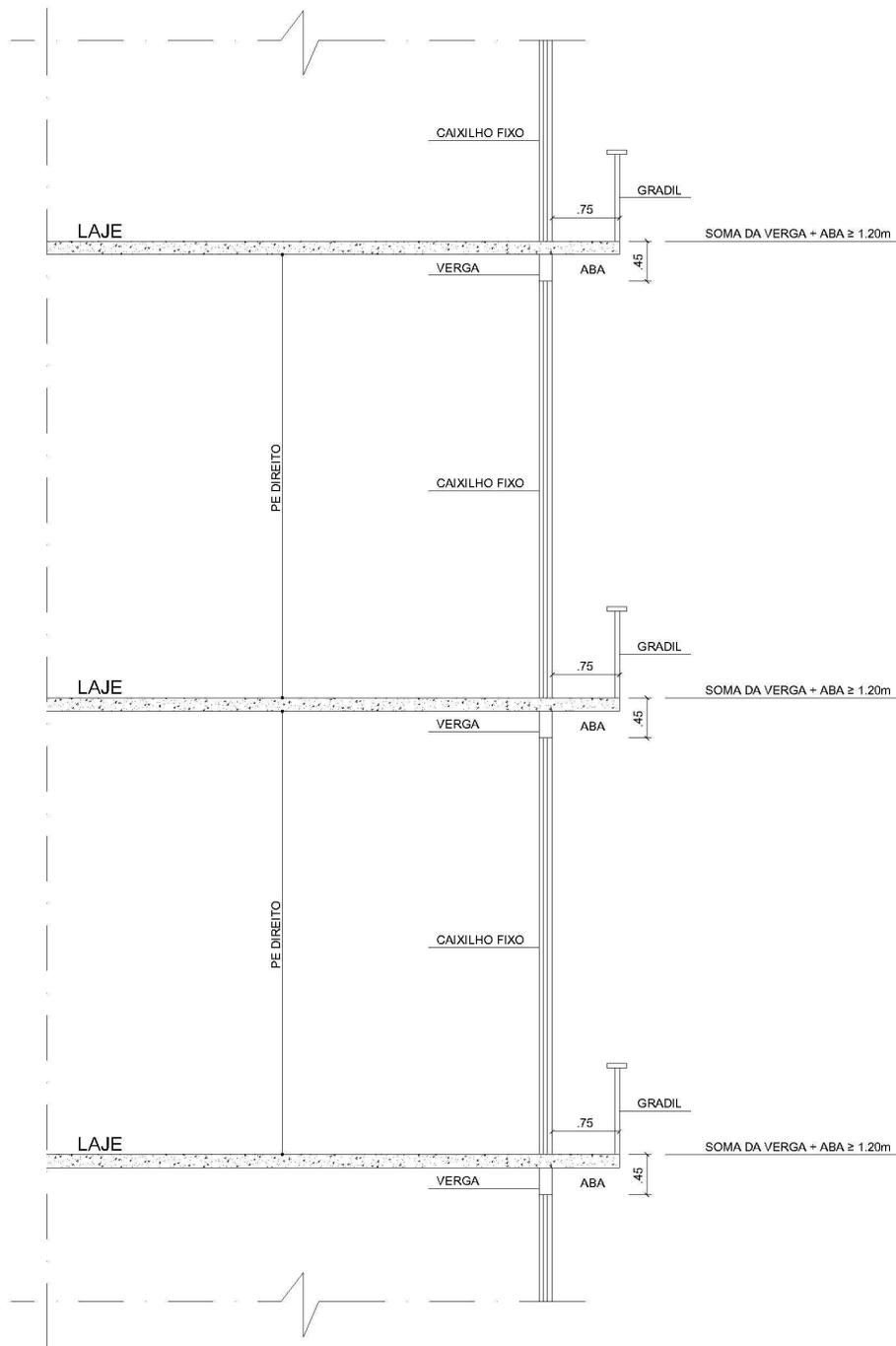
Figura 5 - Exemplo de compartimentação vertical em edificações com risco baixo (composição entre aba e verga-peitoril)
