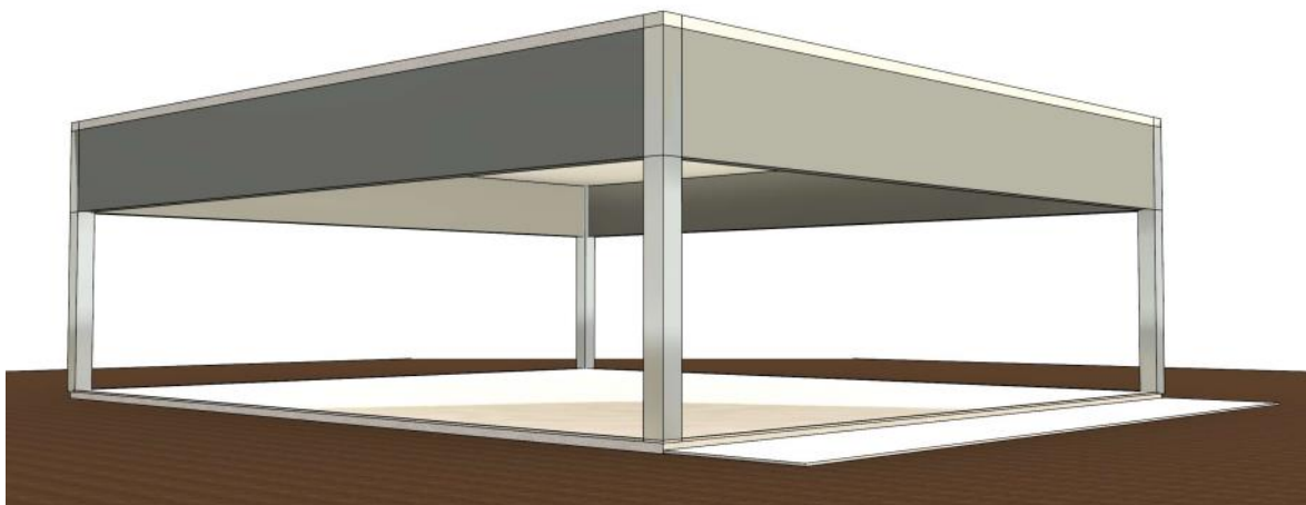
FIGURA 3 – Configuração de aberturas NÃO PERMITIDA por não atender o item 8.1 na íntegra. Nesta imagem, observa-se que, embora exista um percentual de aberturas superior a 50%, as mesmas estão dispostas nas partes inferiores das paredes. Como o acúmulo de fumaça ocorre nas partes superiores, tal configuração não favorece a dispersão da fumaça para fora deste ambiente coberto.
