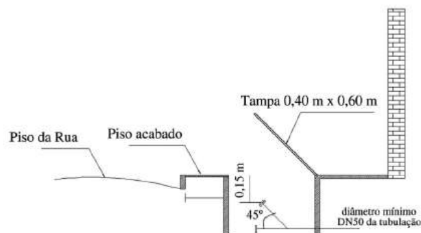
Figura 2 – Dispositivo de recalque no passeio público
