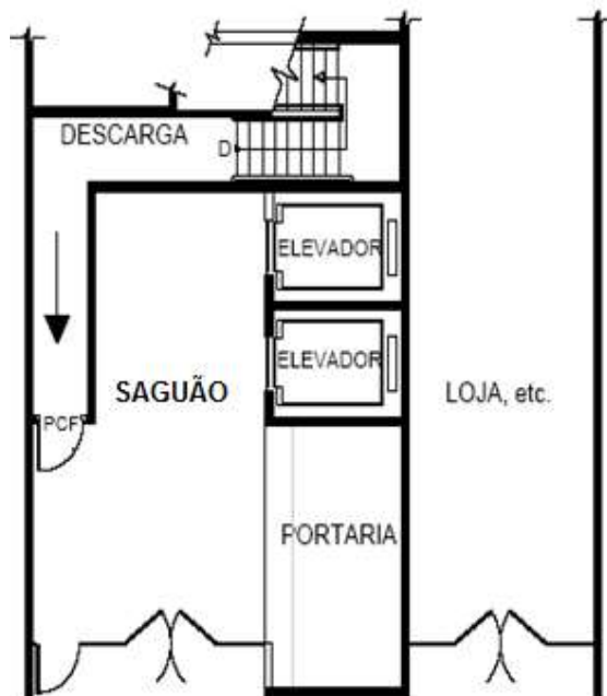
Figura 23 – Descarga através de hall térreo enclausurado
