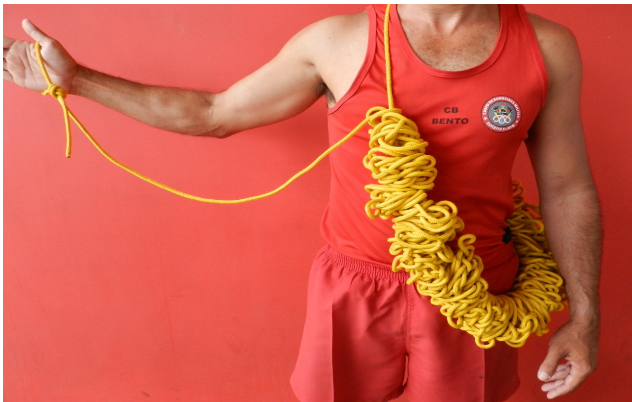
Figura 02 - Cabo guia com bitola de 06 mm, com 60m de comprimento e acondicionamento em forma de coroa. Ideal para uso do apoio de superfície por possibilitar a utilização de grande metragem de cabo, facilidade de manuseio e transporte. O cabo possui carga de ruptura de 345 Kgf/m.
