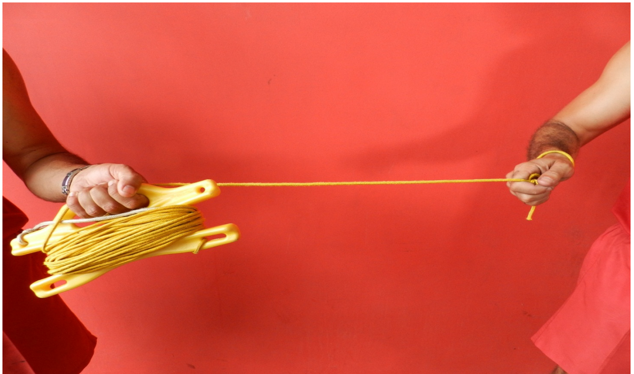
Figura 01 - Cabo guia com bitola de 04 mm, com 30m de comprimento e acondicionado no Enrolador de cabos. Ideal para os padrões de busca que exijam o seu manuseio submerso. O cabo possui carga de ruptura de 178 Kgf/m.
