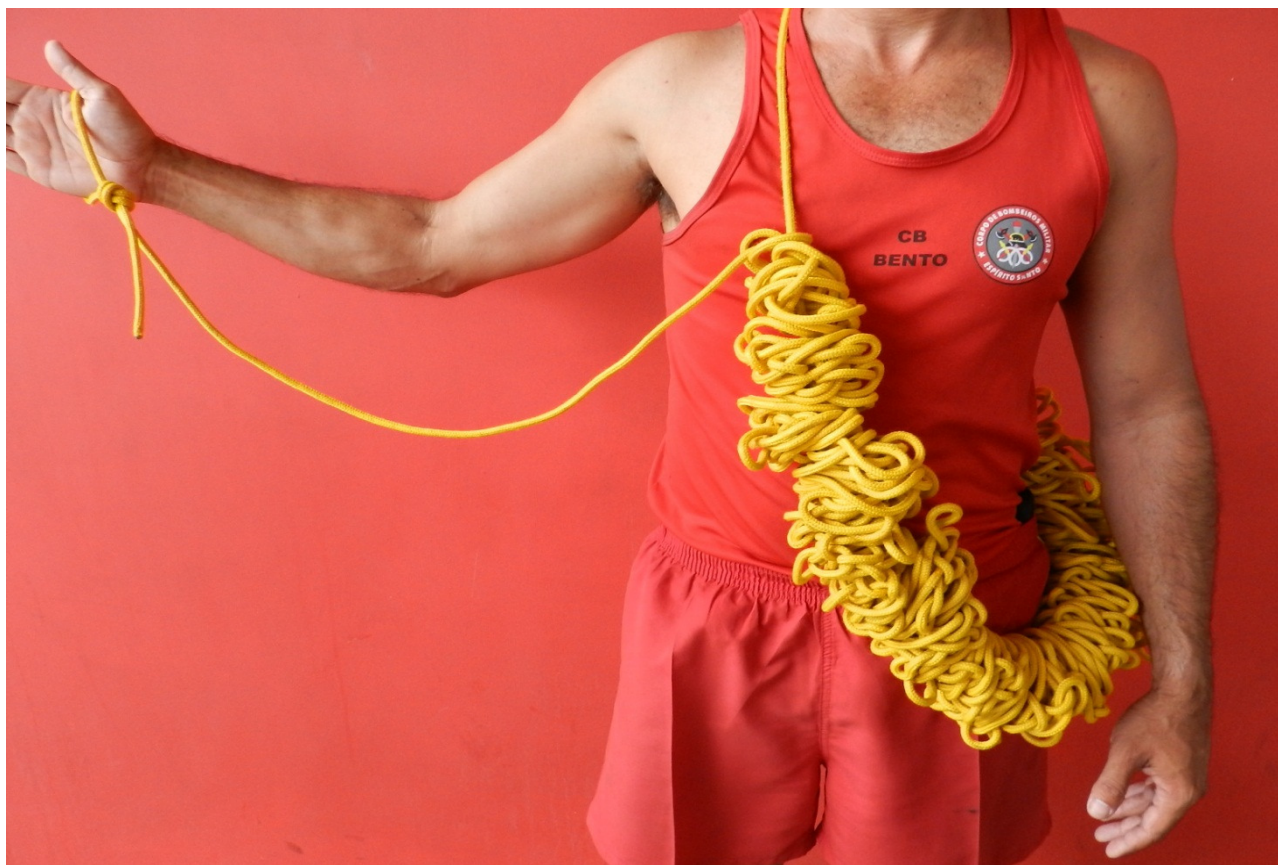
Figura 02 - Cabo guia com bitola de 06 mm, com 60m de comprimento e acondicionamento em forma de coroa. Ideal para uso do apoio de superfície por possibilitar a utilização de grande metragem de cabo, facilidade de manuseio e transporte. O cabo possui carga de ruptura de 345 Kgf/m.
