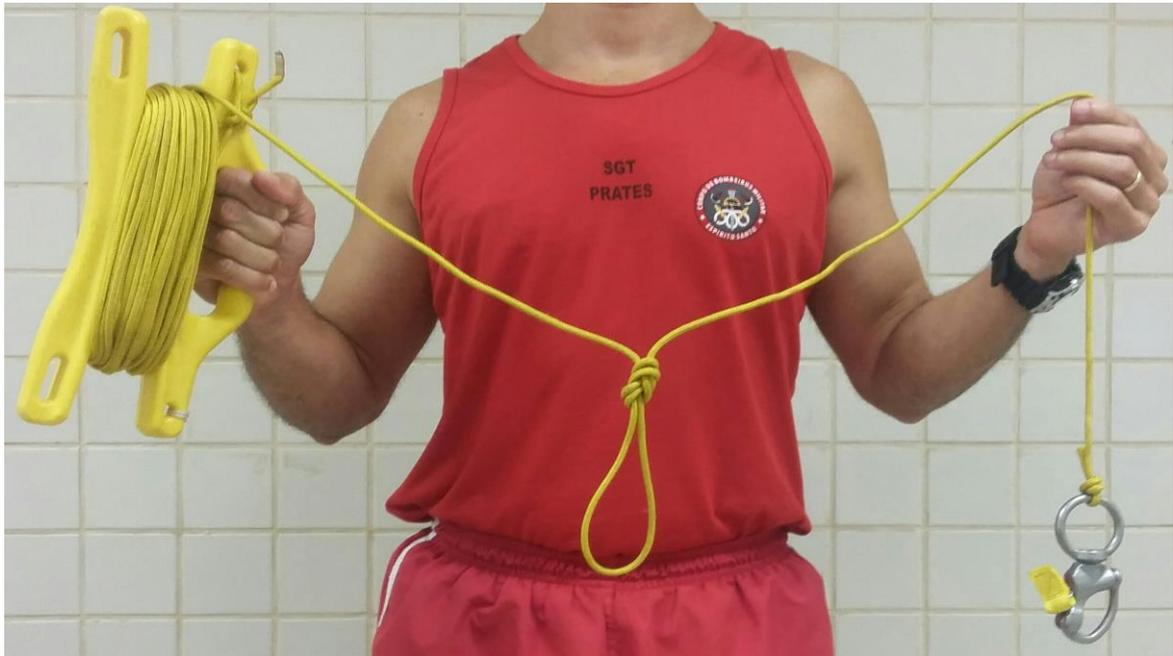
Figura 2 - Cabo guia com bitola de 04 mm, 100% em poliéster, flutuabilidade negativa, cor amarelo, com 30m de comprimento e carga de ruptura de 178 Kgf/m. Acondicionado no Enrolador de cabos é ideal para os padrões de busca e recuperação subaquática do tipo Circular e Varredura em "U" com cabo guiado pela superfície (Arrasto), que exija o seu manuseio pelo Mergulhador de fundo ou Nadador guia de superfície.
