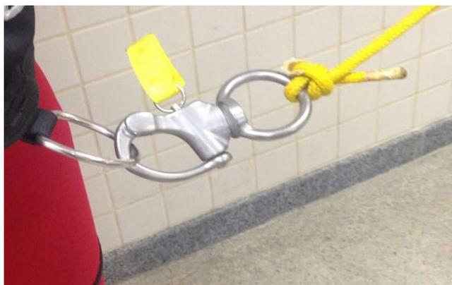
Figura 4.1 – Detalhe da ancoragem do mosquetão de segurança ao D’ring do CE
