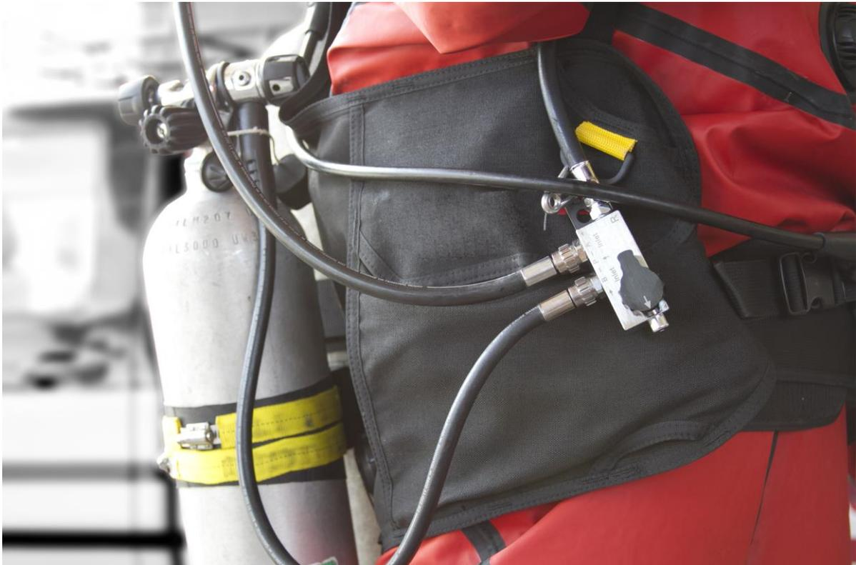
Detalhe do *switch block* (bloco de comutação de gás)
