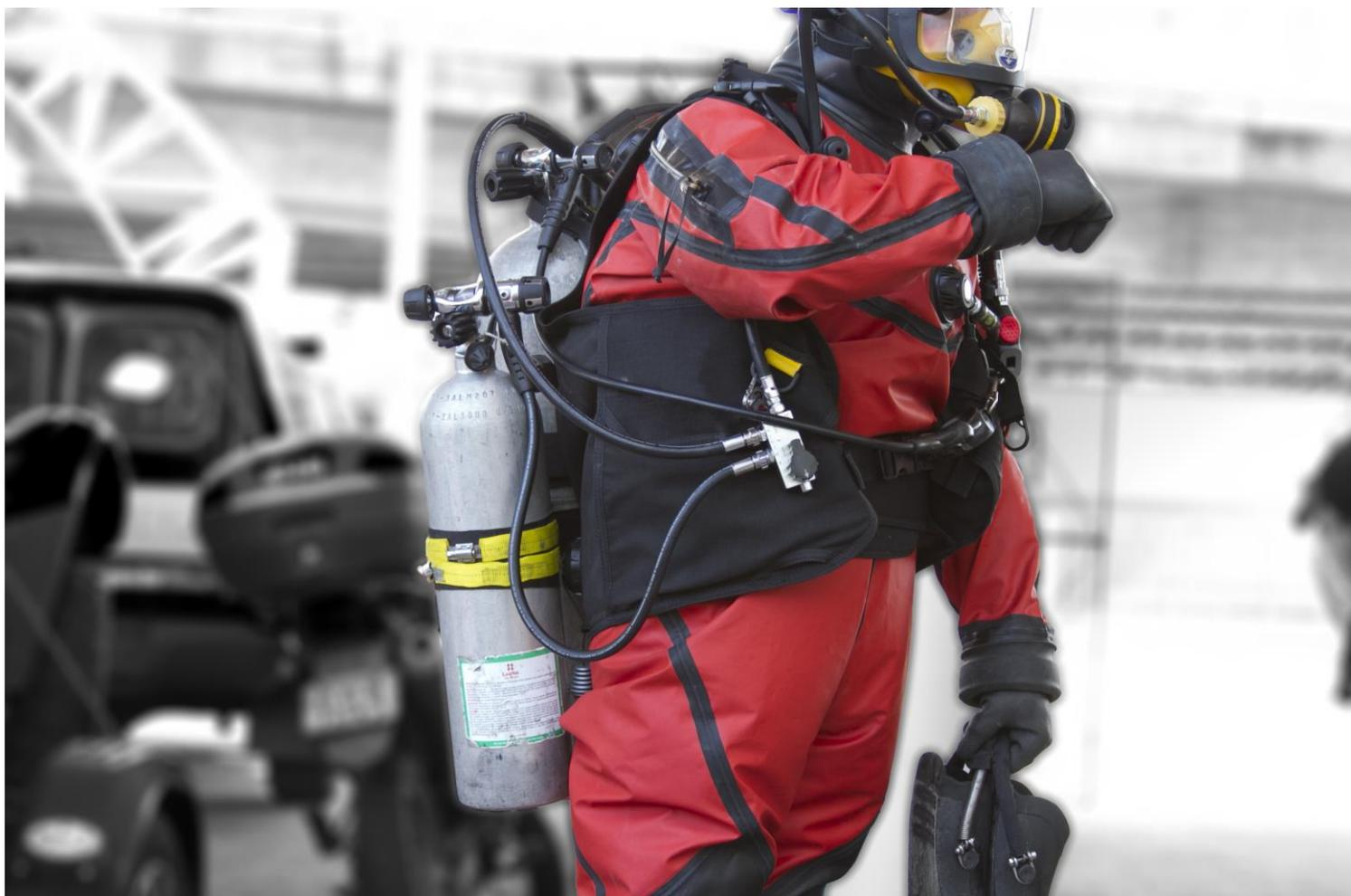
Mergulhador equipado com MFF, roupa seca nível 2 de contaminação, cilindro de bail out e *switch block* (bloco de comutação de gás).
