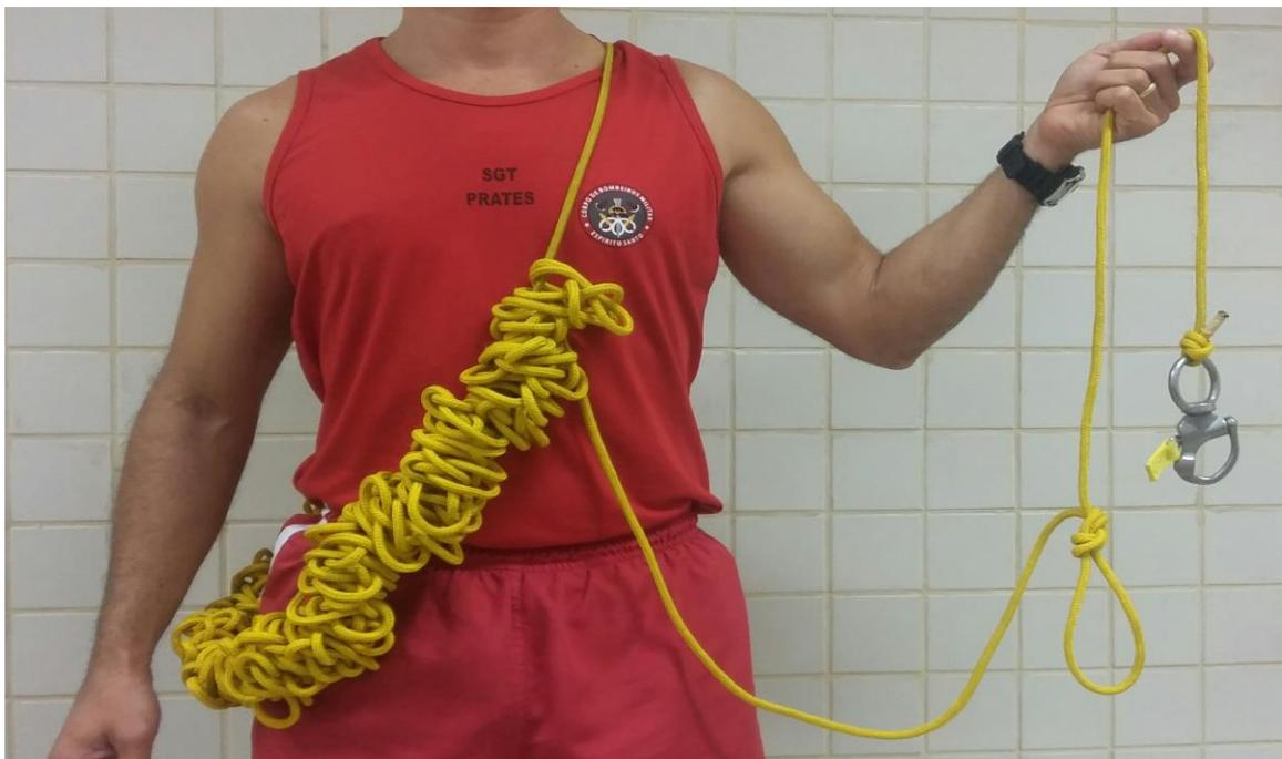
Figura 3 - Cabo guia com bitola de 06 mm, 100% em poliéster, flutuabilidade negativa, cor amarelo, com mínimo de 60m e máximo de 80m de comprimento e carga de ruptura de 345 Kgf/m. Acondicionado em forma de coroa é ideal para uso do Apoio de superfície em padrões de busca e recuperação subaquática do tipo Semicircular, Esquadrinhamento (*Jackstay*) e Caminhada pelo píer, por possibilitar a utilização de grande metragem de cabo, facilidade de manuseio e transporte na superfície.
