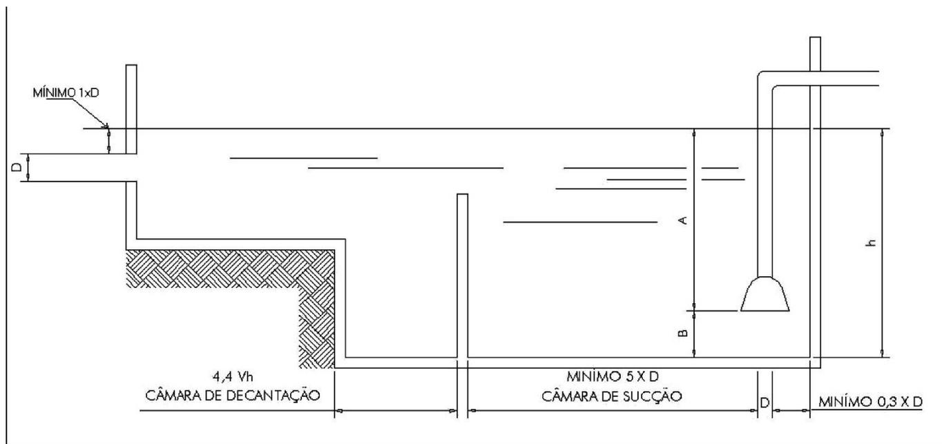
Figura C.6 – Alimentação natural do reservatório por conduto
