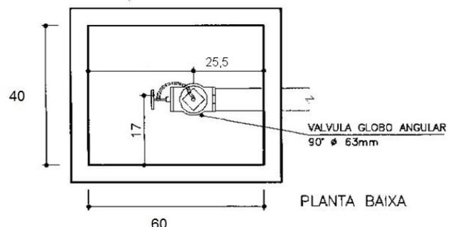
Figura 1 – Dispositivo de recalque no passeio público
