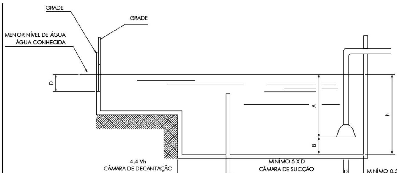
Figura C.5 – Alimentação natural do reservatório por canal
