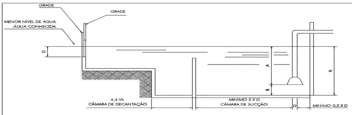
Figura C.4 – Alimentação natural do reservatório de incêndio
