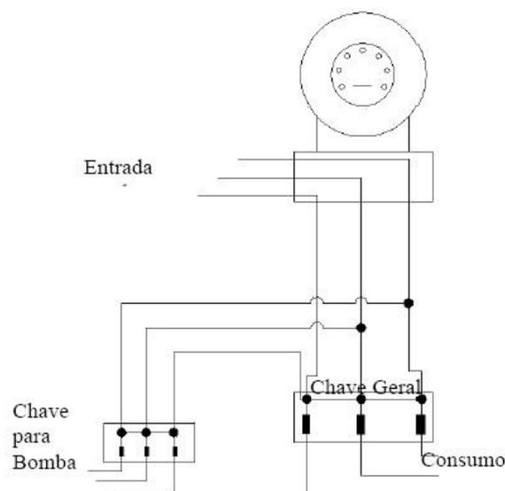
Figura D.4 – Esquema de ligação elétrica para acionamento da bomba de incêndio
