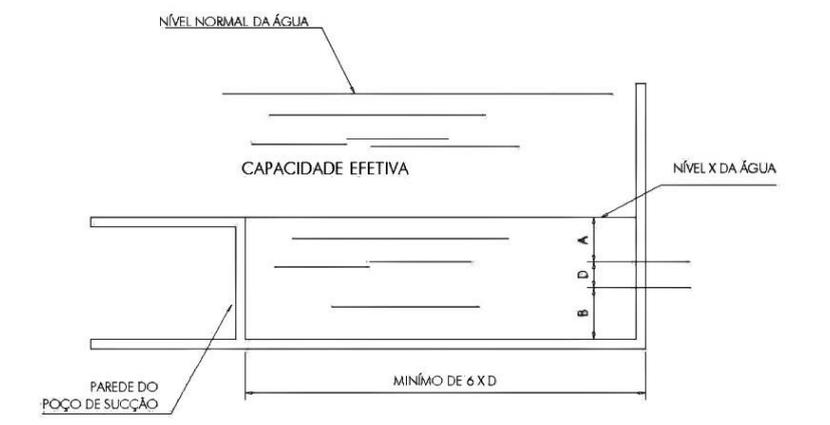
Figura C.2 - Tomada lateral de sucção para bomba principal
