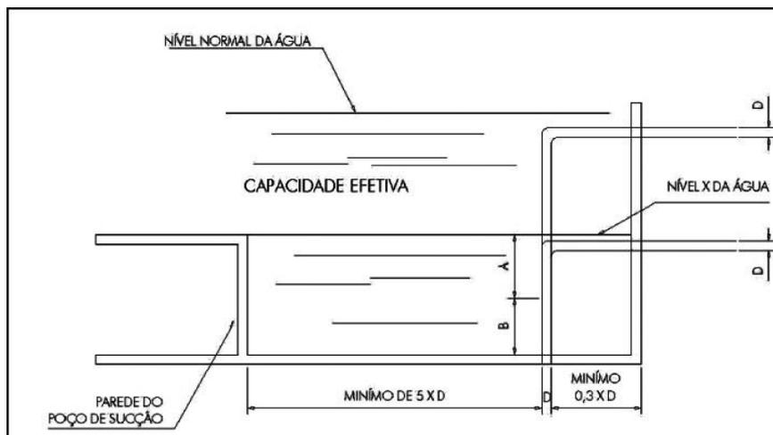
Figura C.1 - Tomada superior de sucção para bomba principal
