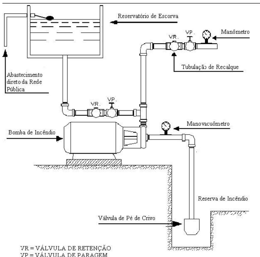
Figura D.3 - Esquema de instalação de bomba de incêndio com sucção acima do nível da água.
