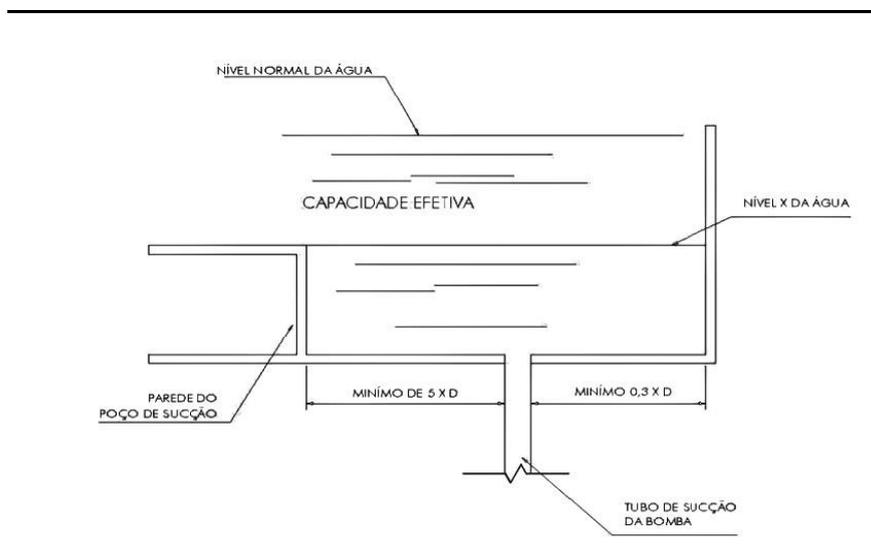
Figura C.3 – Tomada inferior de sucção para bomba principal
